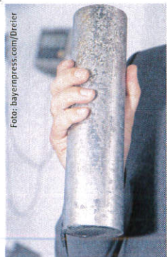
Endprodukt: Über 200 Euro kostet dieser drei Kilo schwere Rohling aus Titan-Aluminid.
